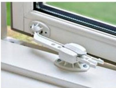
**Балконная ручка с кнопкой без ключа.** Устанавливается на место обычной балконной ручки. Ручка поворачивается только если удерживать кнопку плотно вдавленной (нажатой). Блокируется на проветривание и в закрытом положении.
