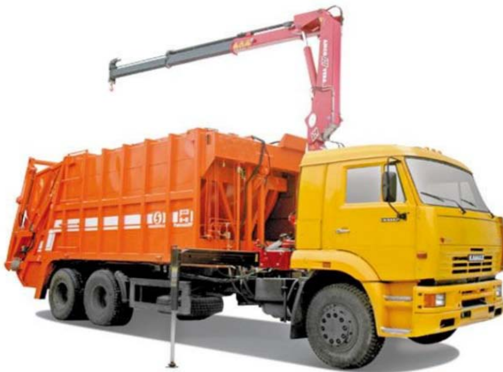
Рисунок 1. Мусоровоз с манипулятором Amco Veba 810-2S на шасси КамАЗ-65117
