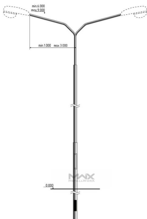
Опора уличного освещения:
