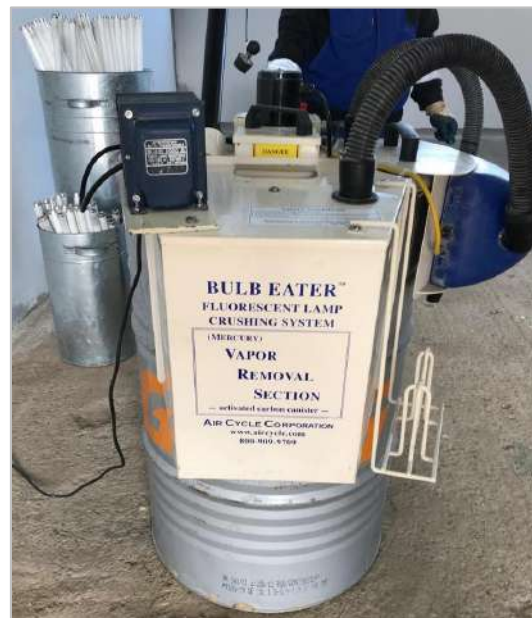
Рисунок 1.17 – Установка по обезвреживанию ртутьсодержащих ламп в г. Стрежевой
